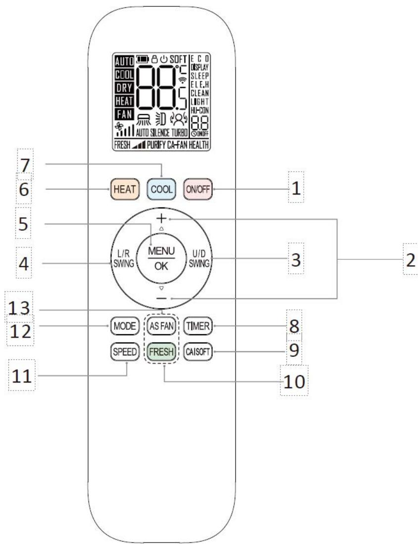
1. **ON/OFF** - zapnutie/vypnutie klimatizácie
